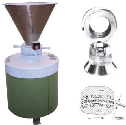
Рис. 3. Коллоидная мельница К6-ФКМ, жернова и схема обработки.
